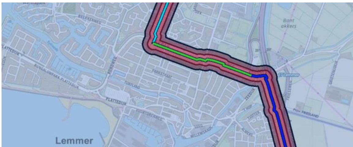
Figuur 7: deel (groen) van aardgastransportleiding N-501-25 waar een het hoogste GR voor berekend is
