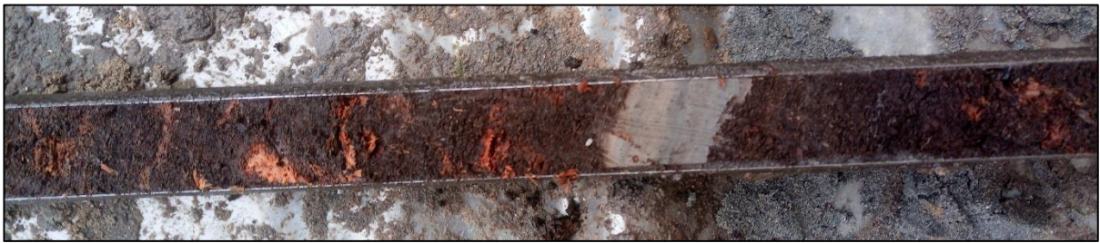
Boring 44, Boven: 0-300 cm -Mv. Onder: detail laagje Duinkerke-I, erosief tussen het Hollandveen.
