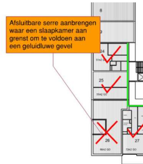
Figuur 5-3: Afsluitbare serre om te kunnen voldoen aan een geluidluwe zijde
