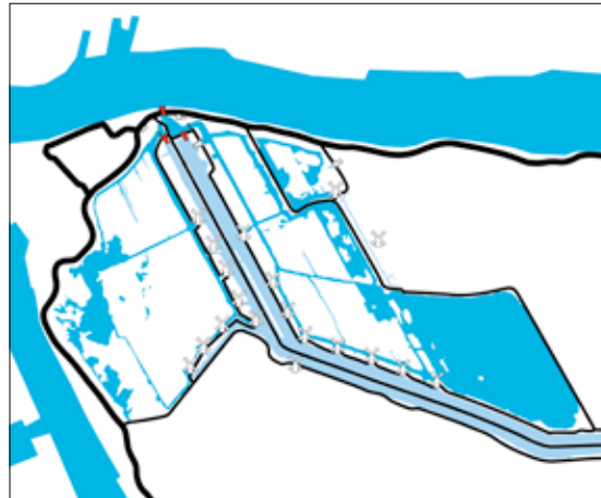
2 e helft 20e eeuw: 2e generatie gemalen, toevoeging 3e maaltrap aan dijk
