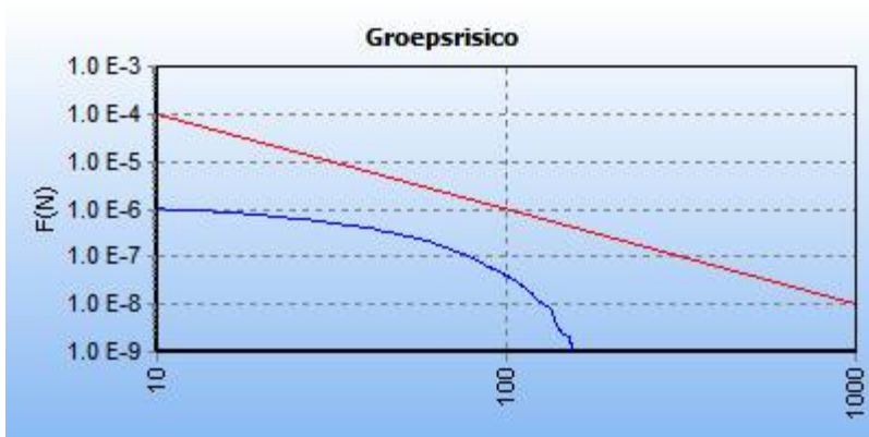
5.1 Figuur 5.3 FN curve voor 5226_leiding-W-514-01-deel-1 van N.V. Nederlandse Gasunie voor de kilometer tussen stationing 3210.00 en stationing 4210.00
