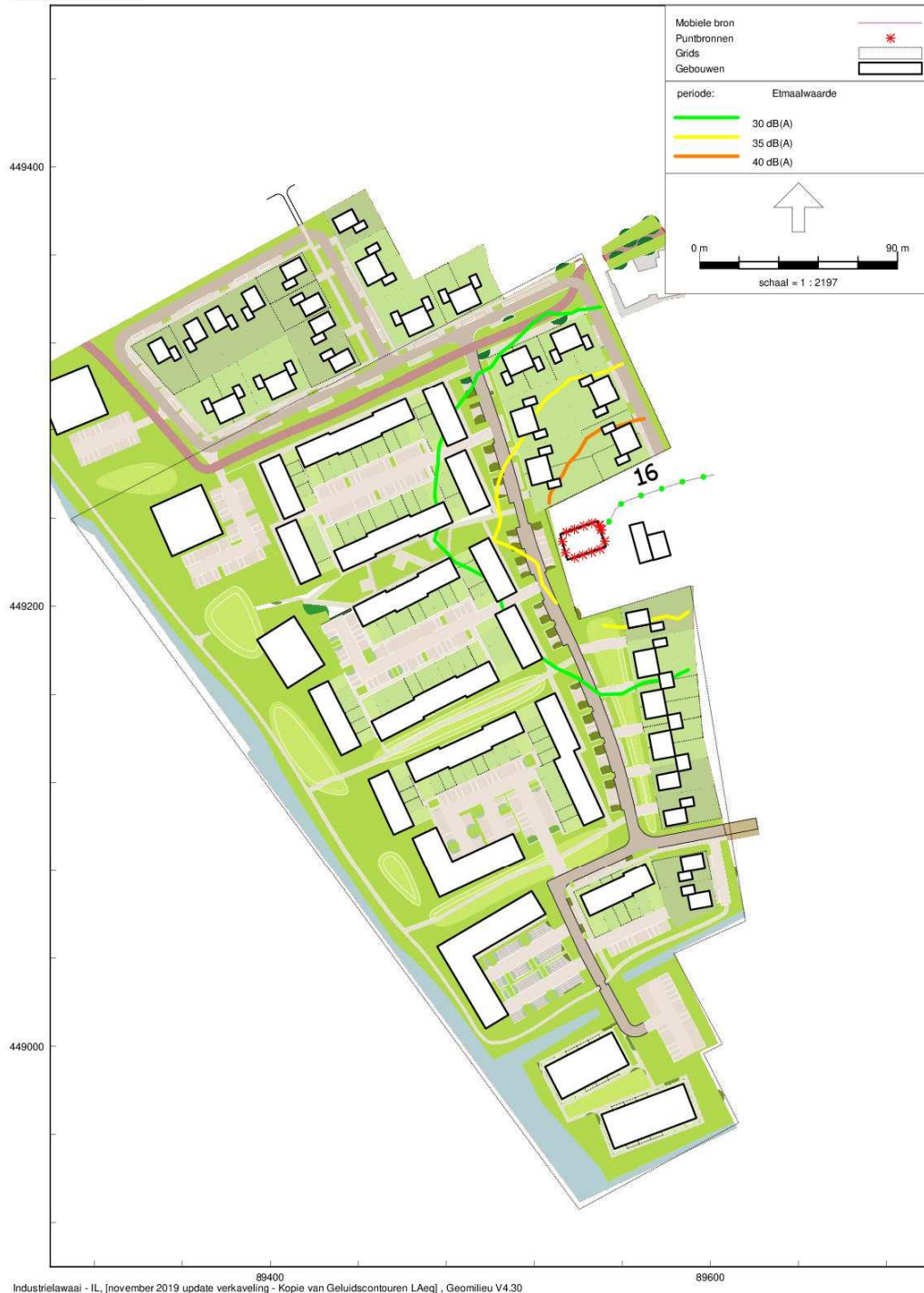
figuur 1 geluidscontouren langtijdgemiddeld beoordelingsniveau op een hoogte van 5 meter, veroorzaakt door Bloemengroothandel Peter Hofman (oranje contour = 40 dB(A); gele contour = 35 dB(A); groene contour = 30 dB(A) etmaalwaarde)
