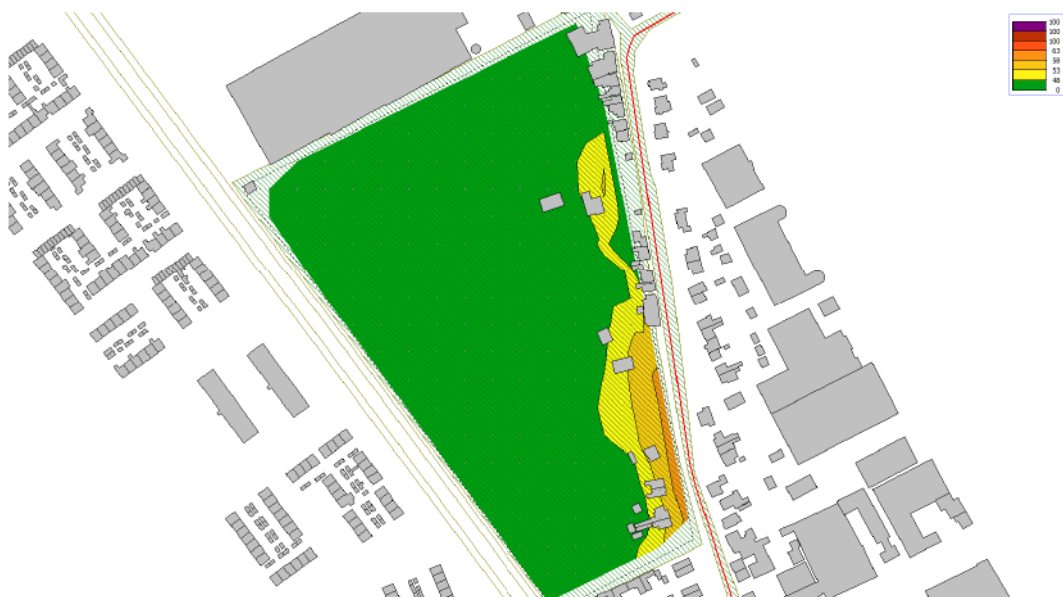
figuur 2 indicatie geluidsbelasting Vlielandseweg
