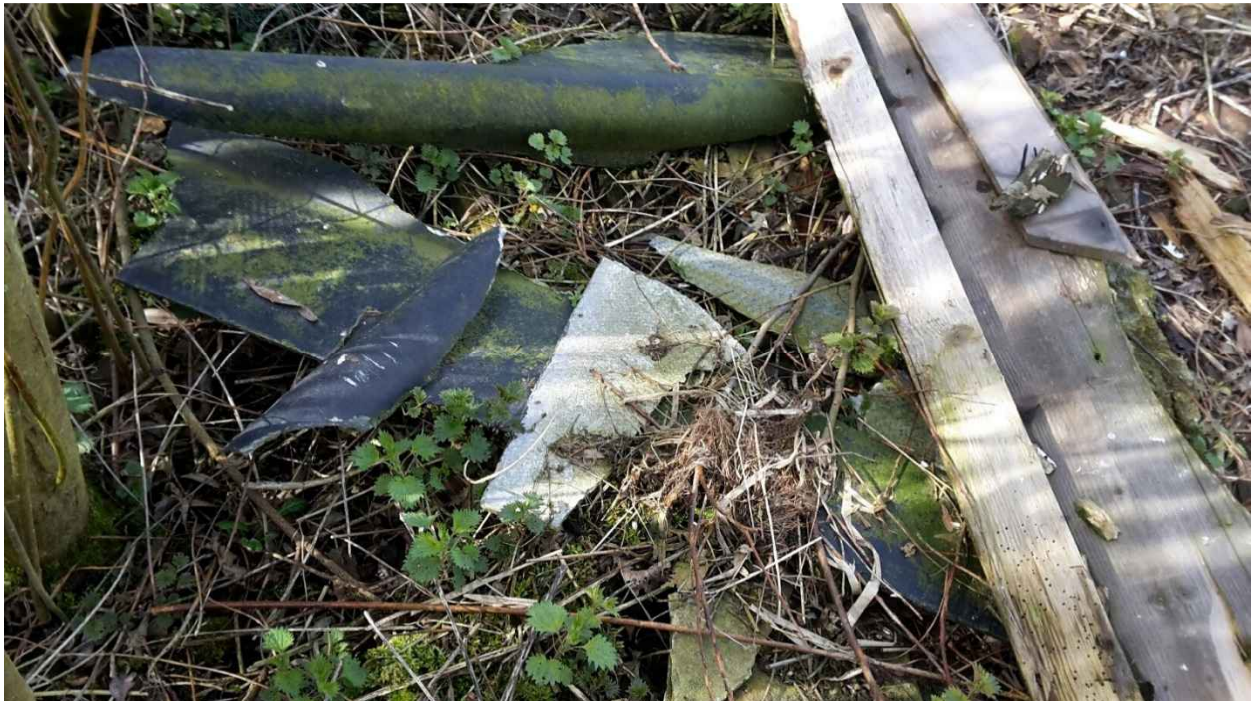
Foto 1: Asbestverdacht plaatmateriaal, gezien in westelijke richting.
