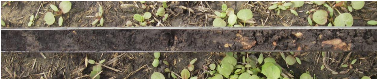
Figuur 14: Foto van boring 6 met daarop het in het vergraven veen aangetroffen baksteenpuin
