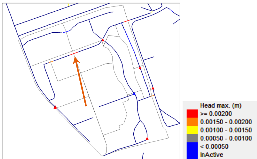
Figuur 18: Verval in duikers tijdens normafoer (inzet van aflat). Eén nieuwe duikers zonder peilscheidende functie heeft een opstuwung van meer dan 2mm.
