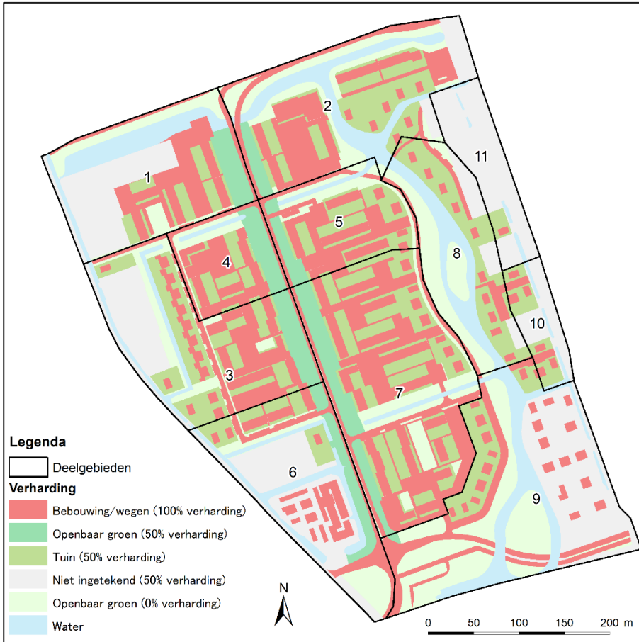
Figuur 3: De vlakkenkaart met verschillende landgebruikstypes en afwateringseenheden.
