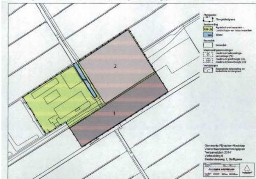
b. Schema van het bouwplan dat de Bieslandhoeve wil realiseren. 1 = de stal ("koeientuin"), 2. Terrein voor logistieke activiteiten (landschappelijk in te passen).
