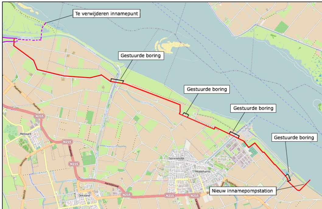
Figuur 2.8 Tracé nieuwe drinkwatertransportleiding (rood). Paars = bestaande transportleiding (solide lijn: blijft bestaan, gestippelde lijn: wordt verwijderd) (Ondergrond: OpenStreetMap.org contributors under CC BY-SA 2.0 license).
