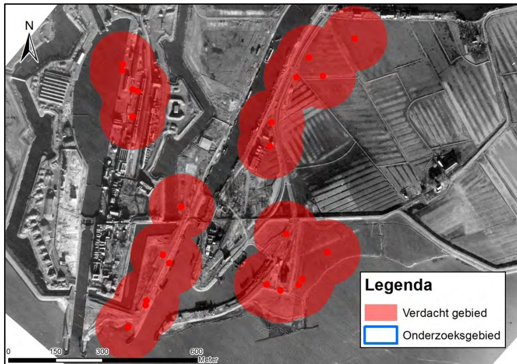
Figuur 23 De afbakening van het verdachte gebied bij Hellevoetsluis op afwerpmunitie. Verdacht is 105 meter rond de bomkraters.
