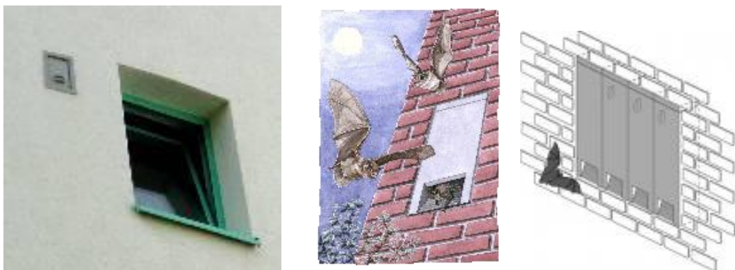
Buitenaanzicht gebouw met inpandige vleermuisvoorziening. Bron: Schwegler
