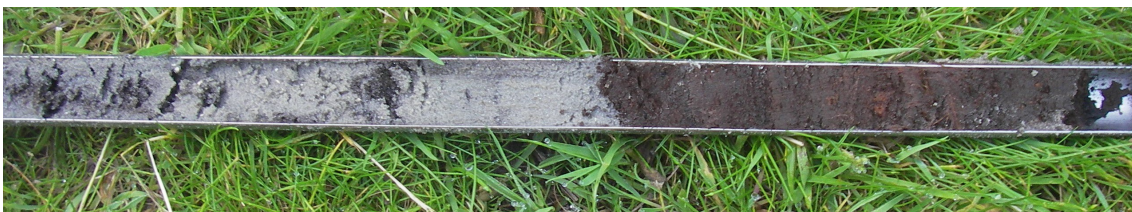
Figuur 6. Lemmer, Tjalk en Schokker. Foto van boring 6 met links het zwak schelphoudende zand en rechts matig veraard veen met een erosieve bovengrens.
