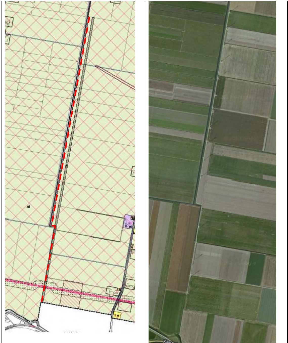
Figuur 24 Uitsnede uit het bestemmingsplan Buitengebied 2006 (links) en feitelijke opstelling windturbines (rechts). De rode gestreepte lijn geeft de nieuwe aanduiding voor windenergie-installaties aan
