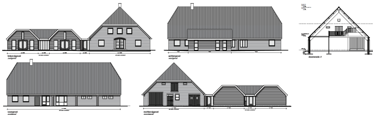
Gevelaanzichten en dwarsdoorsnede bestaande situatie
