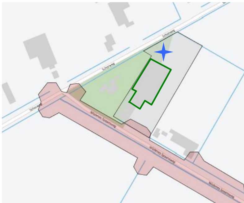
Figuur 25 Uitsnede kaart met zone primaire waterloop en beoogde bouwlocatie (blauwe ster) en globaal te slopen bebouwing (groen kader)
