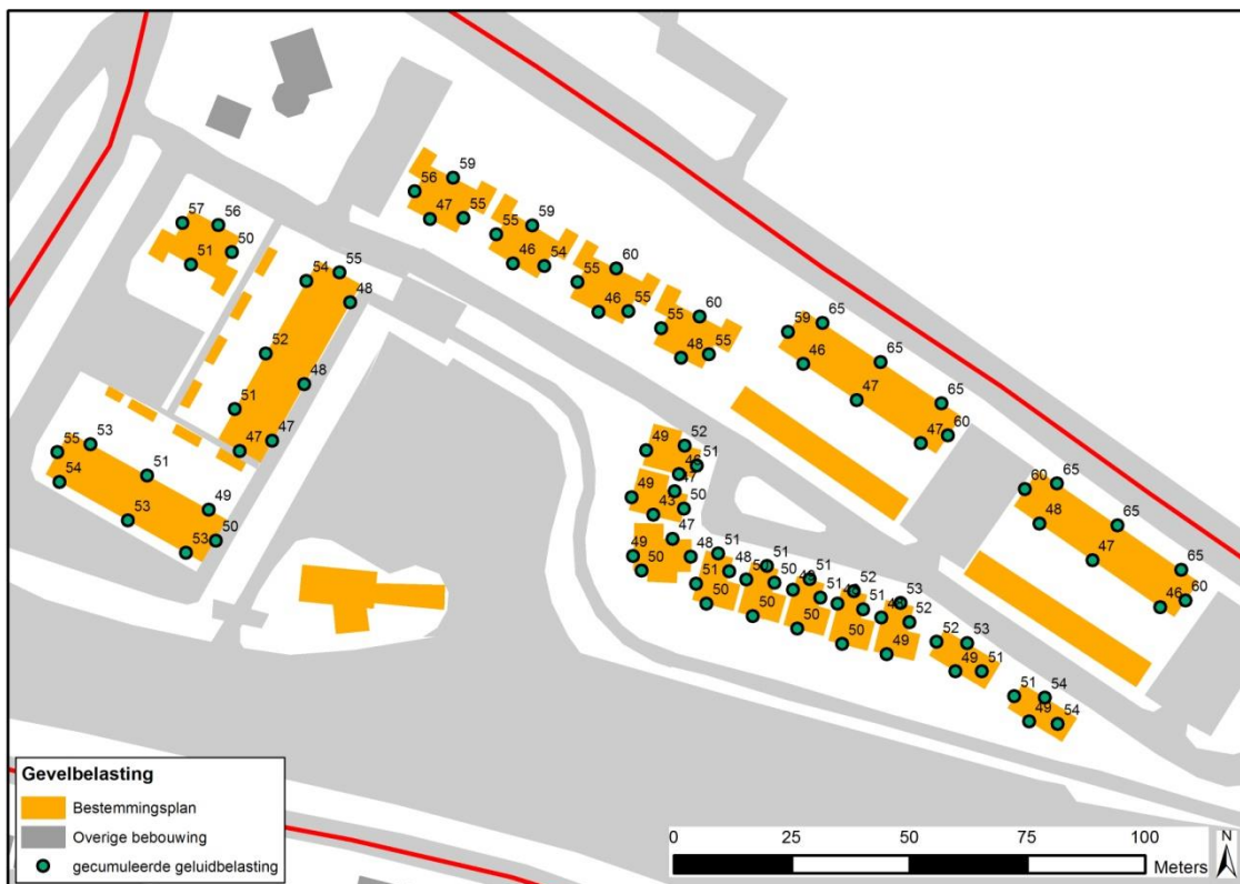
Figuur 5.2 Gecumuleerde geluidbelasting
