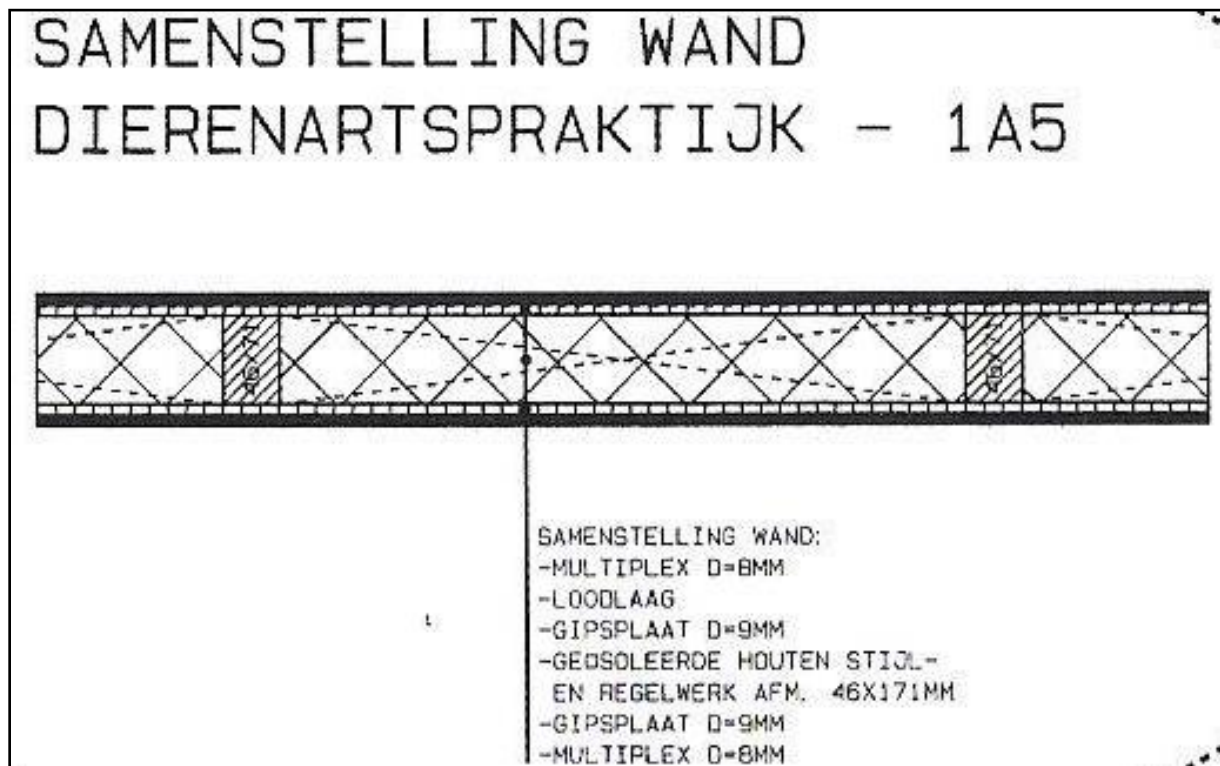
figuur 5 samenstelling wanden van de röntgenkamer
