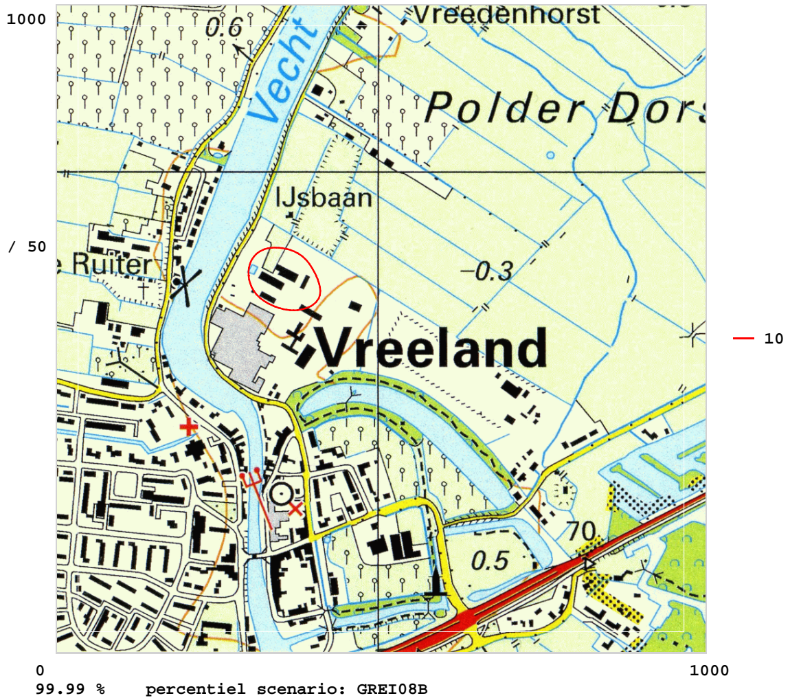
Figuur e: Geurcontour van 10 \text{ge}/\text{m}^3 als 99,99-percentielwaarde (rood) als gevolg van Greif Nederland BV te Vreeland in de situatie na de ingebruikname van de nieuwe regeneratieve naverbrander.
