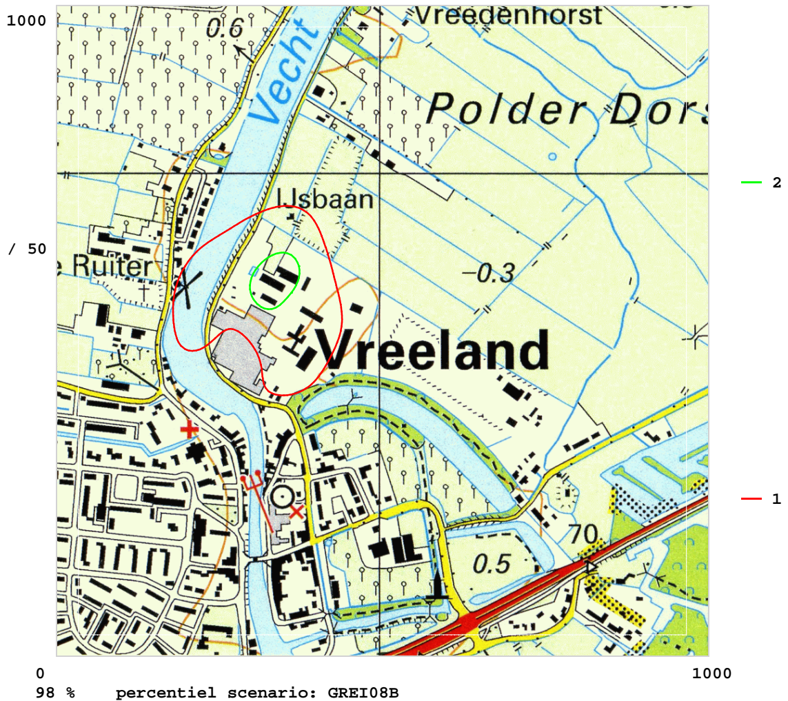
Figuur d: Geurcontour van 1 (rood) en 2 (groen) ge/m 3 als 98-percentielwaarde als gevolg van Greif Nederland BV te Vreeland in de situatie na de ingebruikname van de nieuwe regeneratieve naverbrander.
