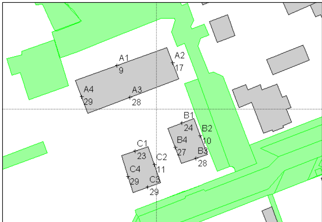
Figuur 2 Hoogst berekende geluidbelasting vanwege de Middenweg (60 km/uur) inclusief aftrek conform artikel 110g Wgh
