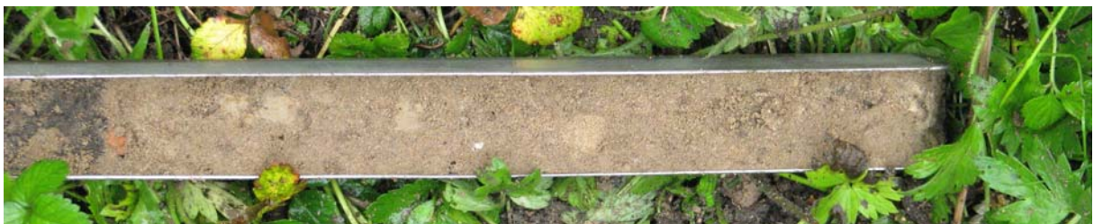
Figuur 12b: Foto van boring 23. Hierop is onder de humusrijke toplaag het matig humeuze, zwak kleiige zand te zien dat gekenmerkt wordt door een rommelige opbouw met veel brokken. Duidelijk zijn brokken van kleiiger materiaal herkenbaar.
