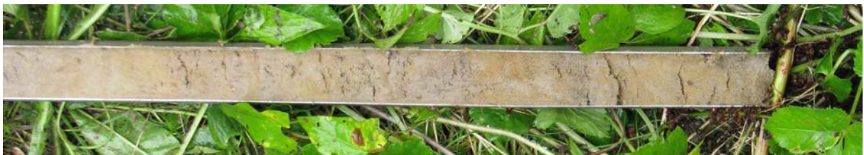
Figuur 12c: Door kleilaagjes onderbroken zand zoals in boring 4 is aangetroffen.
