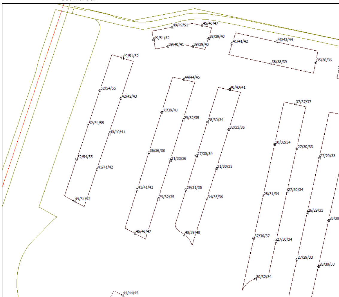
Figuur 5.4: overzicht van de berekende geluidbelasting L_{den} in dB vanwege de spoorlijn Sneek-Leeuwarden
