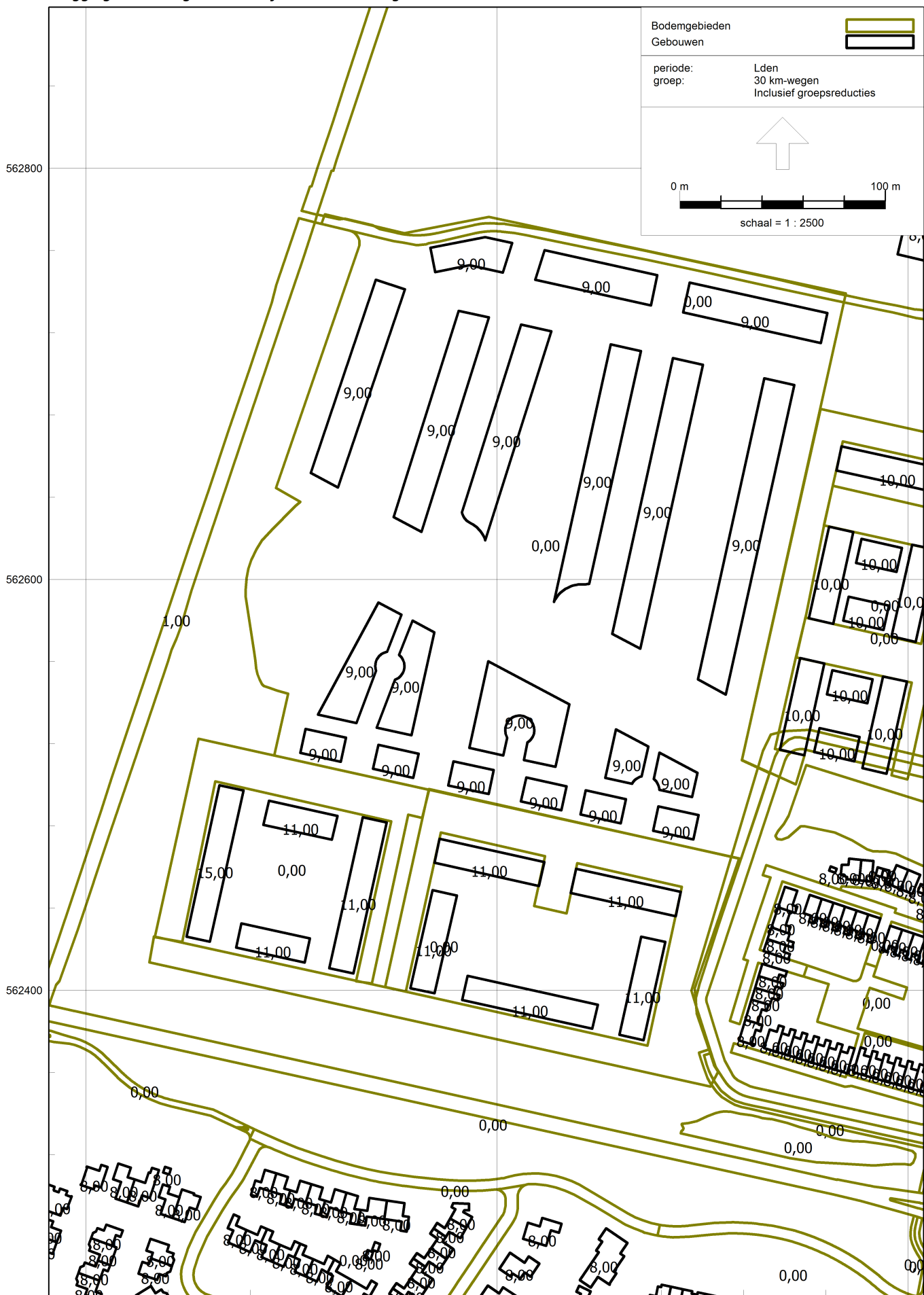
Figuur 1: overzicht van het wegverkeerslawaai rekenmodel met de ligging van de ingevoerde objecten en bodemgebieden
