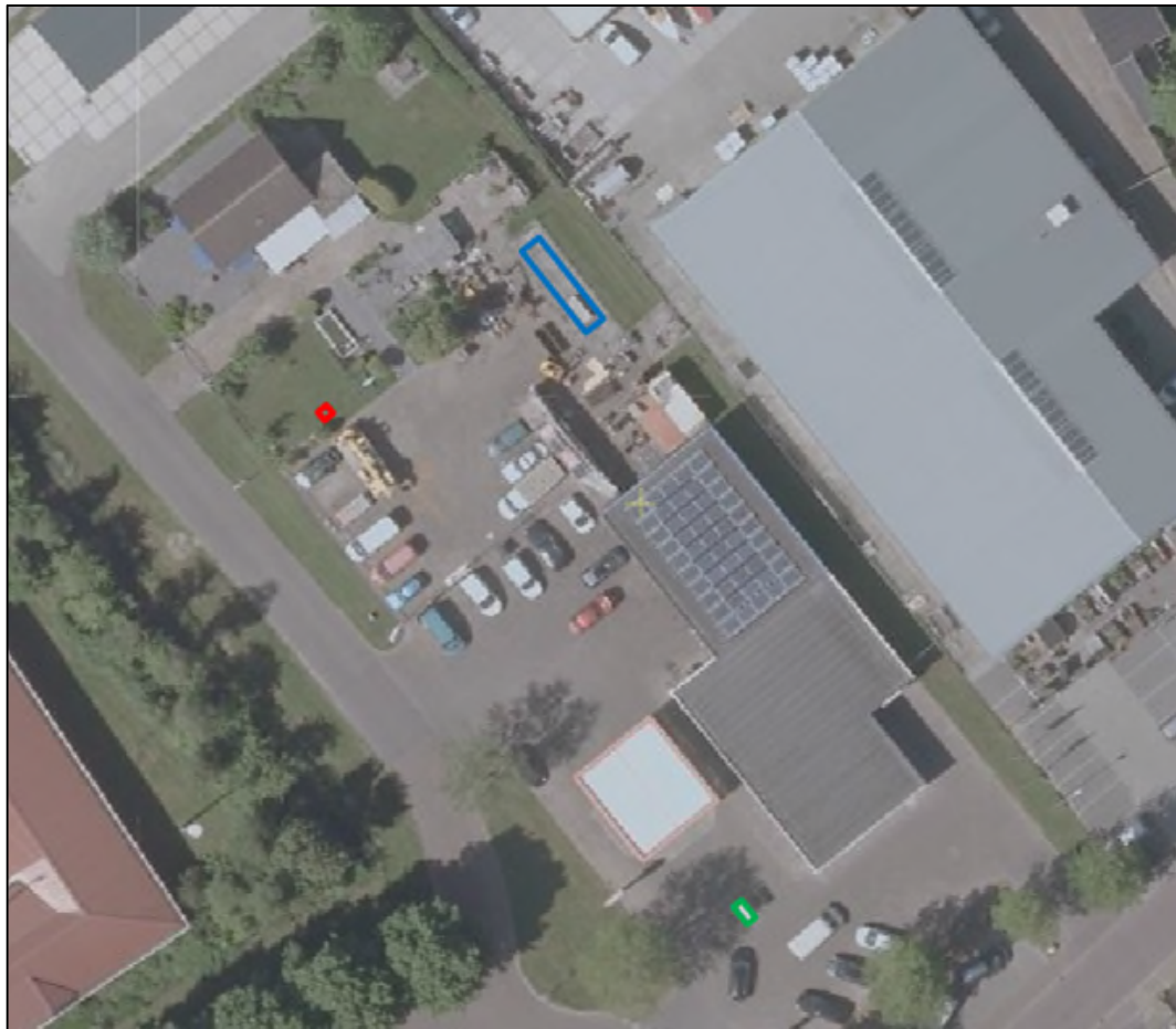
Figuur 3.2 - Tankstation met LPG-vulpunt (rood), ondergrondse tank (blauw), LPG-afgiftepunt (groen) (bron: Globespotter)
