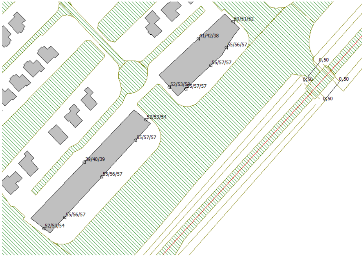
Figuur 4 Geluidsbelasting terugliggende bebouwingslijn (begane grond \leq 57 dB = \leq 53 dB incl. correctie)
