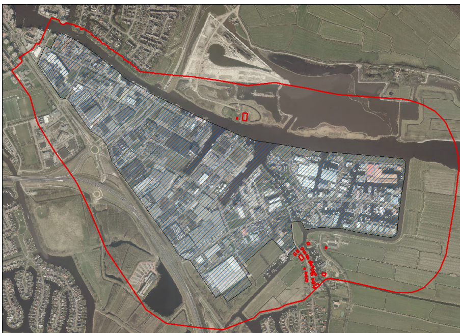
Figuur 7. Geluidzonerings rondom bedrijventerrein Houkesloot / 't Ges en begrenzing van het geluidgezoneerde deel van het bedrijventerrein
