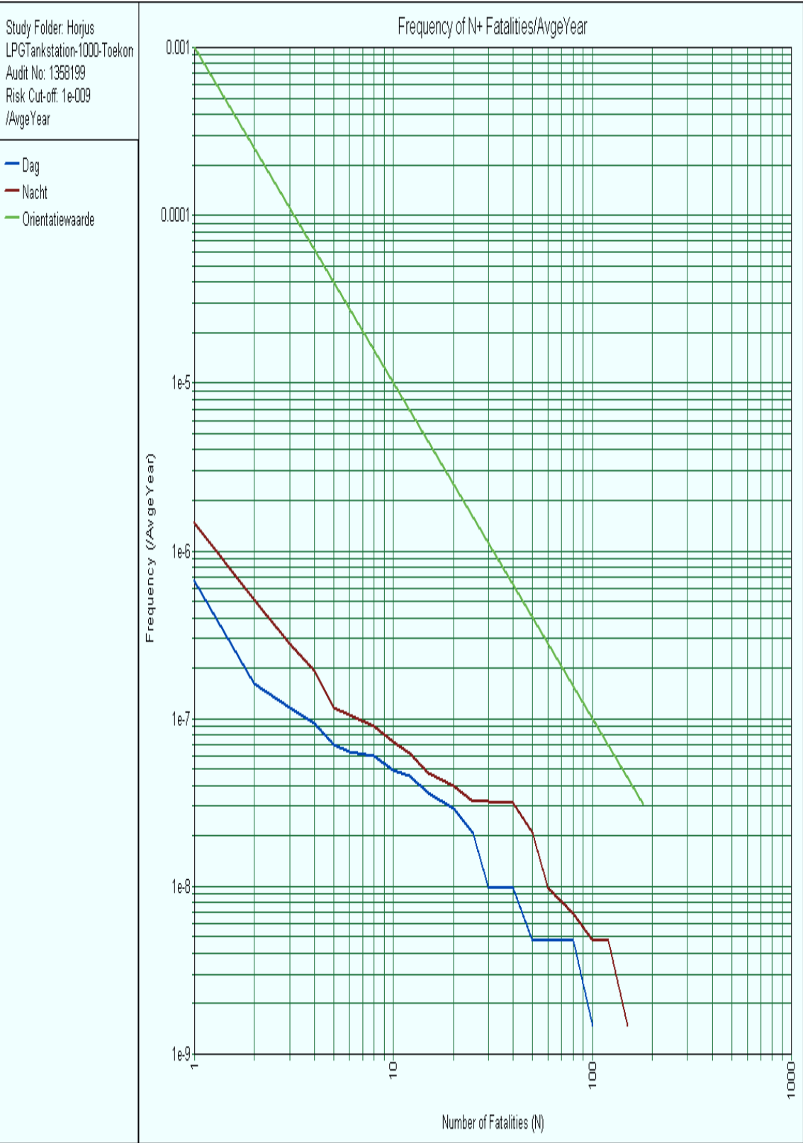
Groepsrisico LPG-tankstation tankauto voorzien van hittewerende bekleding voor twee tijdvensters voor de bevoorrading doorzet 1000 m 3 /jr
