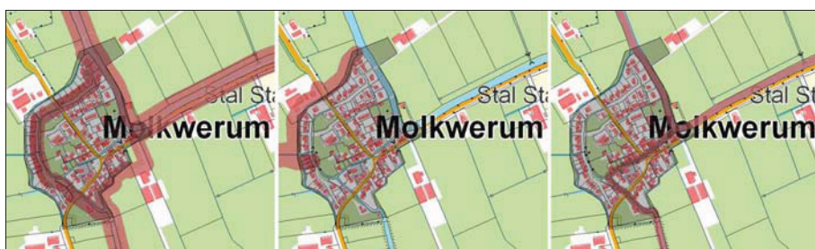
Figuur 10. De waterelementen in Molkwerum, respectievelijk de regionale waterkering, de lokale waterkering en de hoofdwaterring (bron: Wetterskip Fryslân)
