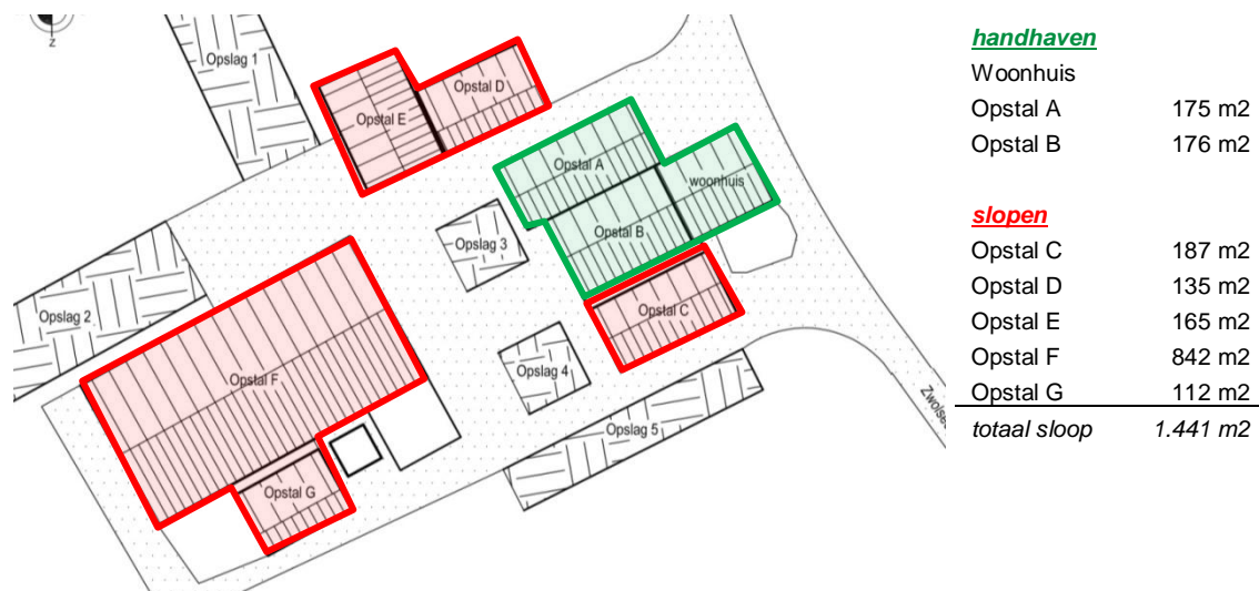
afbeelding 16: Te slopen en te behouden bebouwing op perceel Zwolsedijk 16
