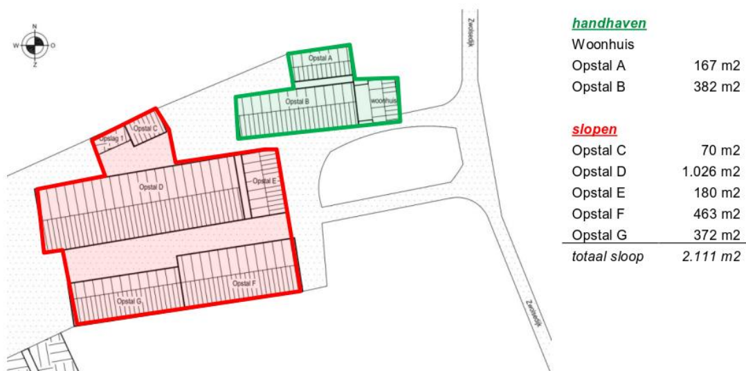
Figuur 4.1 Te slopen bebouwing Zwolsedijk 10
