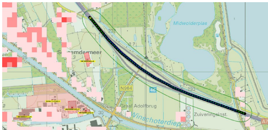
Figuur 10: Overzicht invoer RBMII en inzicht in plaatsgebonden risico 10^{-8} in het groen
