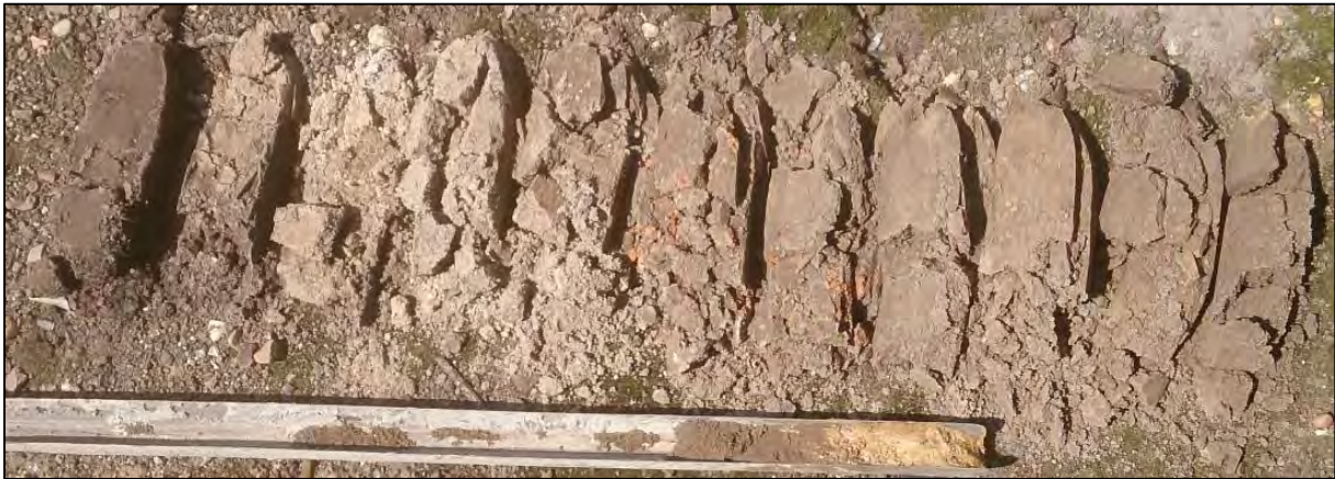
Figuur 4: Het profiel van boring 3b.
