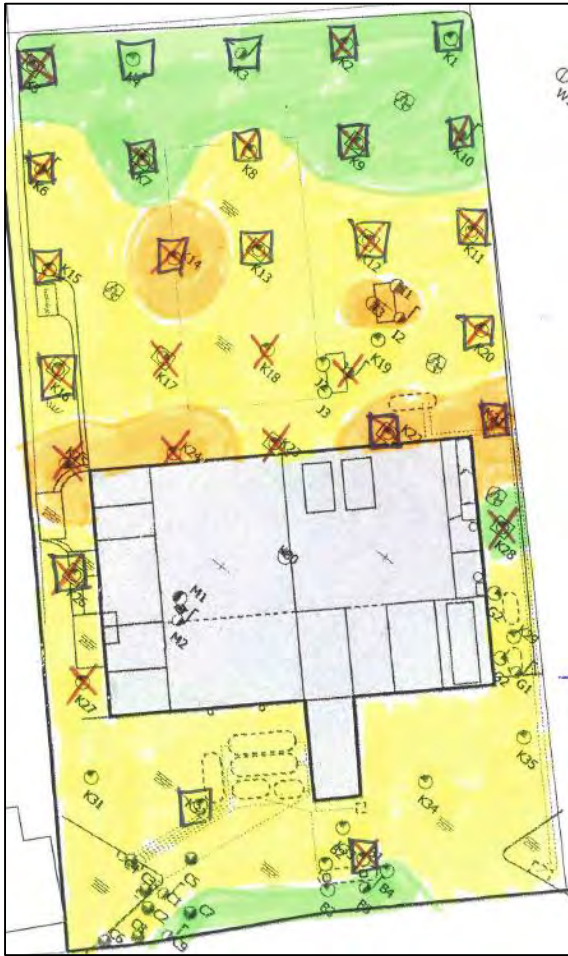
Figuur 8: Diepte van de C-Horizont geëxtrapoleerd uit het milieukundig booronderzoek uitgevoerd door Econsultancy. Groen is 50, geel is tussen de 50 en 100 en oranje is dieper dan 100 centimeter –mv. Een vierkant rond een boorpunt duidt op een vermoed A-C profiel, een rood kruis op de aanwezigheid van baksteen, beton, puin, koolgruis en zinkas boven of in de C-Horizont (Hartingsveld 2015, met toevoeging van kleurcodering)
