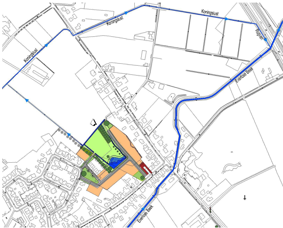
Figuur 3: Uitgewerkt schetsontwerp inclusief benodigde watergangen voor vertragde afvoer.
