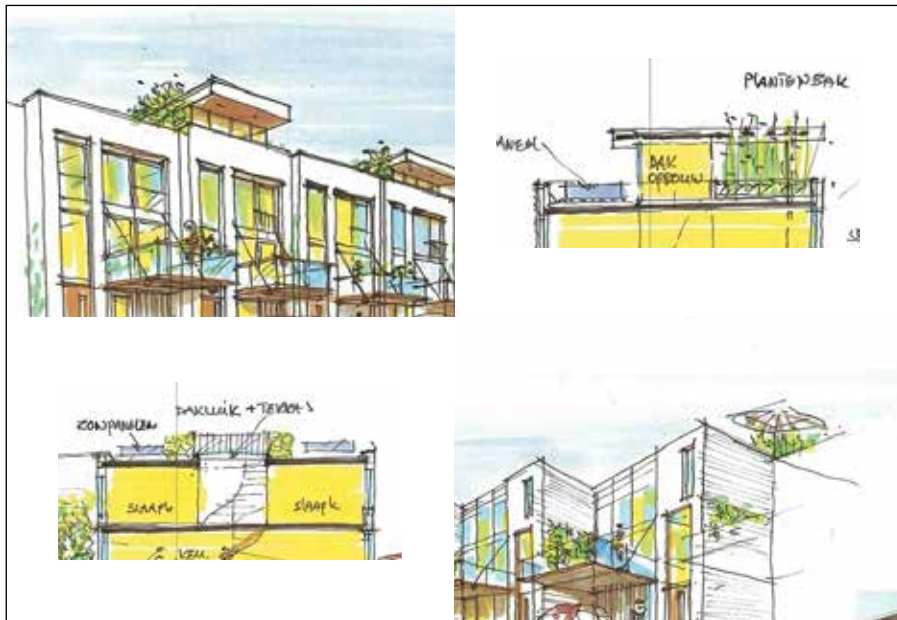
Vierde bouwlaag: geen, dakterras of dakopbouw
