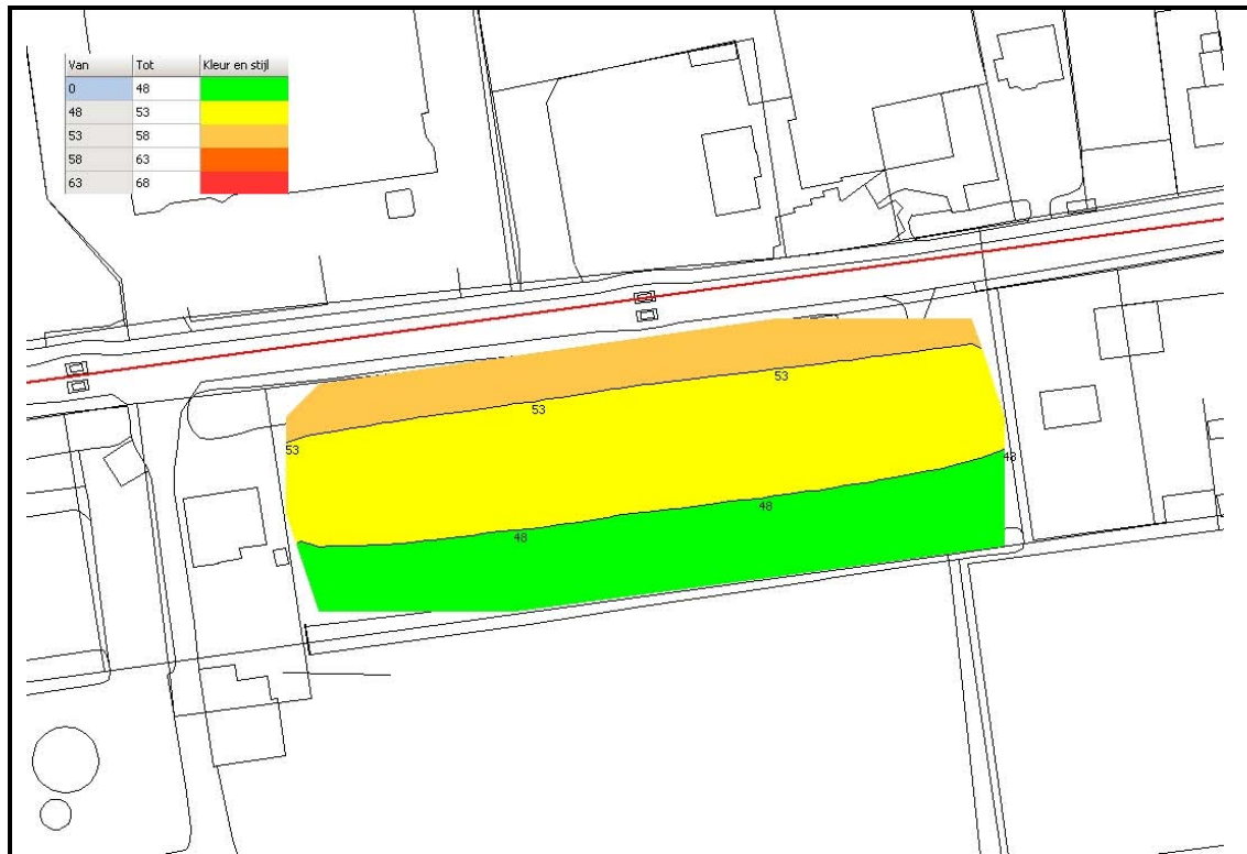
Figuur 11: Geluidsbelasting ten gevolge van de Moerkapelse Zijde in dB incl. correctie ex. Art. 110g Wgh
