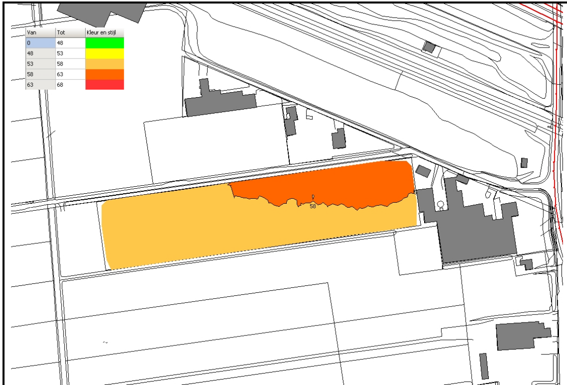
Figuur 18: Geluidsbelasting ten gevolge van de Rijksweg A12 in dB incl. correctie ex. Art. 110g Wgh
