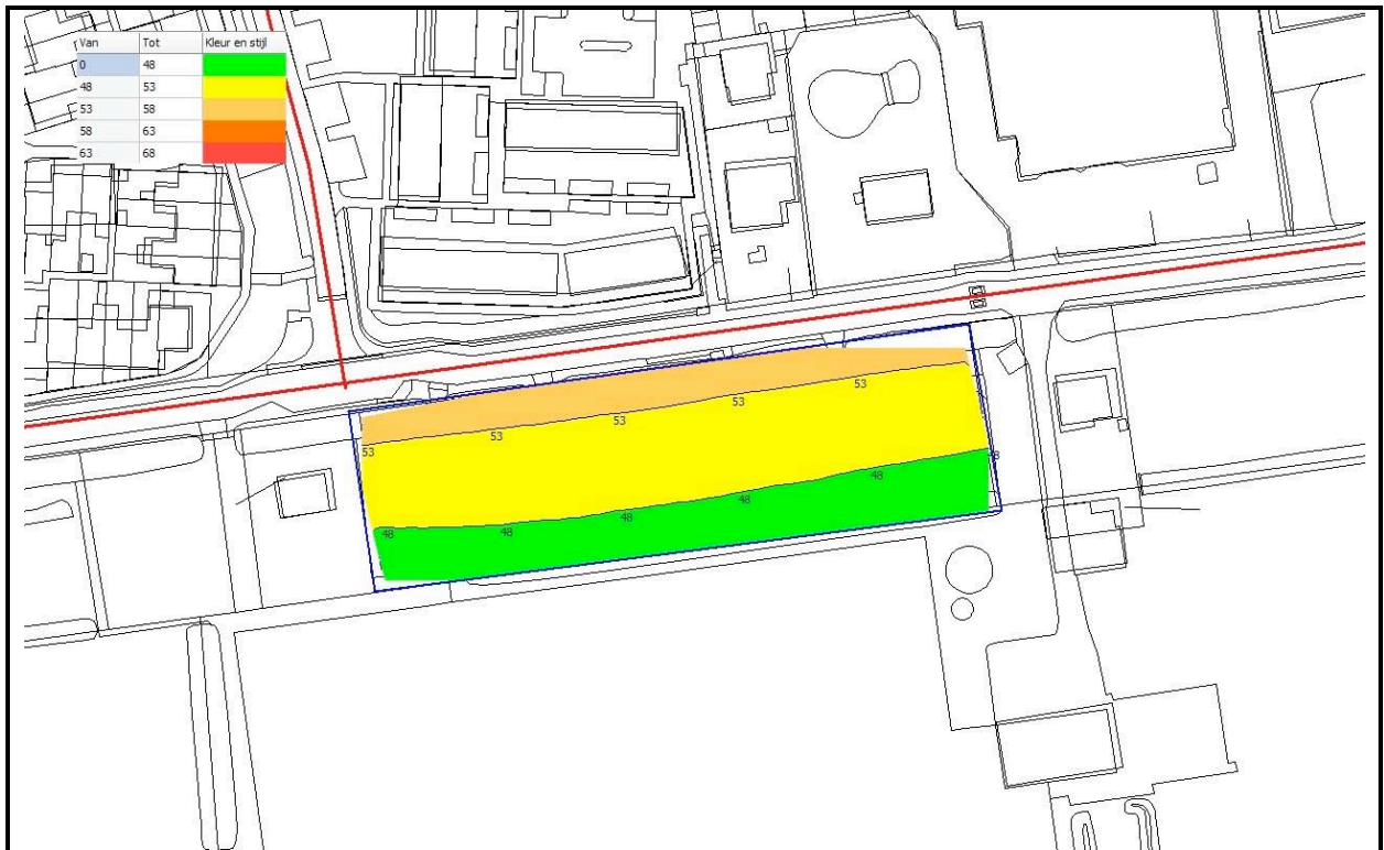
Figuur 2: Geluidsbelasting ten gevolge van de Moerkapelse Zijde in dB incl. correctie ex. Art. 110g Wgh
