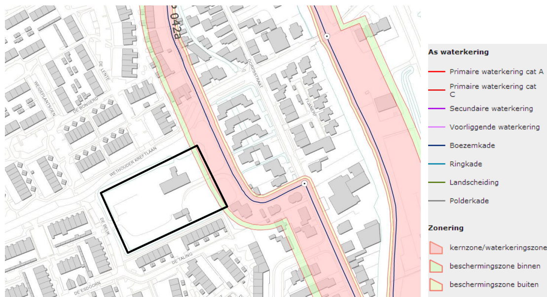
Afbeelding 3.10: legger waterkeringen Hoogheemraadschap Schieland en Krimpenerwaard
