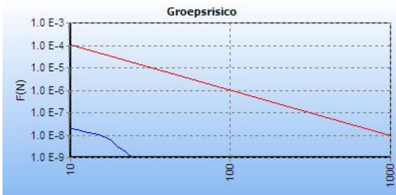
Figuur 5.1 FN curve voor A_803 van N.V. Nederlandse Gasunie voor de kilometer tussen stationing 70580.00 en stationing 71580.00
