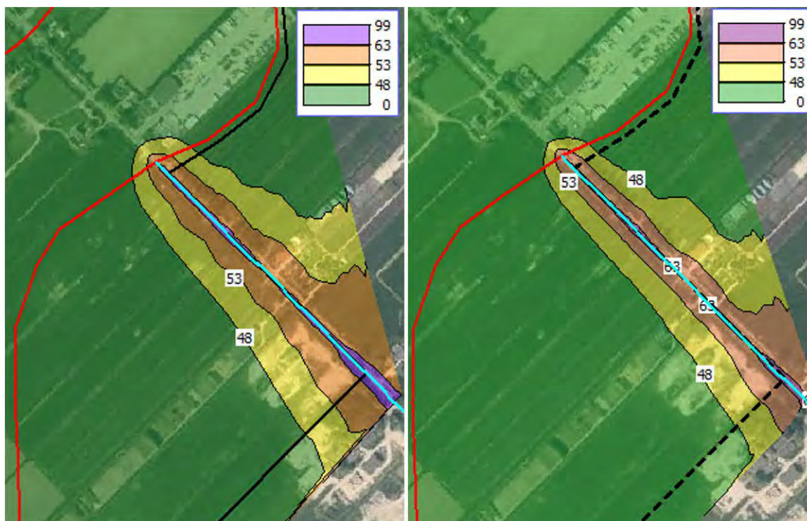
Figuur 11 Wegverkeerslawaaï van de Middelweg, zonder (links) en met (rechts) het toepassen van een dunne deklaag type A.
