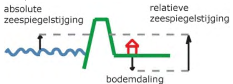
Figuur 11-11 | Relatieve zeespiegelstijging = absolute zeespiegelstijging + bodemdaling
