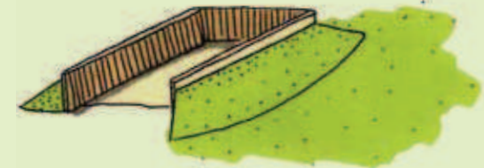
Sleufsilo inpassen met lage grondwal
