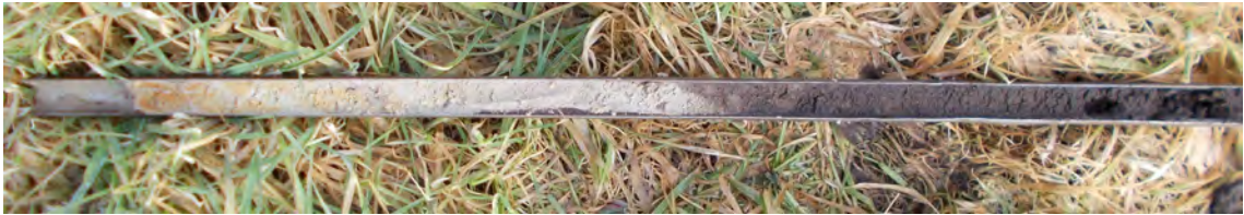
Figuur 10: Damwâld, Haadwei: De keileem (links) zoals deze in de boringen 5 tot en met 9 en 12 onder de vergraven toplaag (rechts) is aangetroffen.
