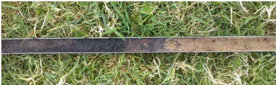
Figuur 6. Feanwâlden, 't Landeke. Foto van boring 29 met in het midden een dun laagje sterk veraard veen en rechts daarvan de vernatte en doorwortelde top van het dekzand.
