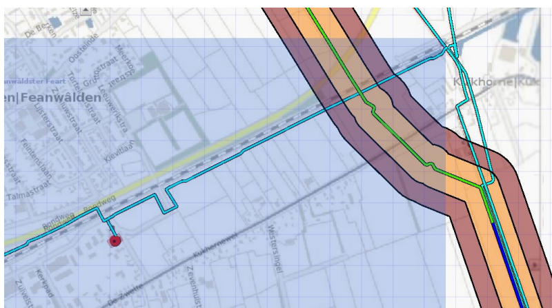
Figuur 13: deel (groen) van aardgastransportleiding A-596 waar een GR berekening is uitgevoerd
