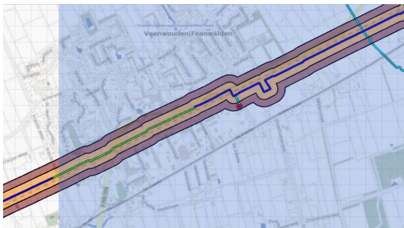
Figuur 11: deel (groen) van aardgastransportleiding N-505-30 waar een GR berekening is uitgevoerd
