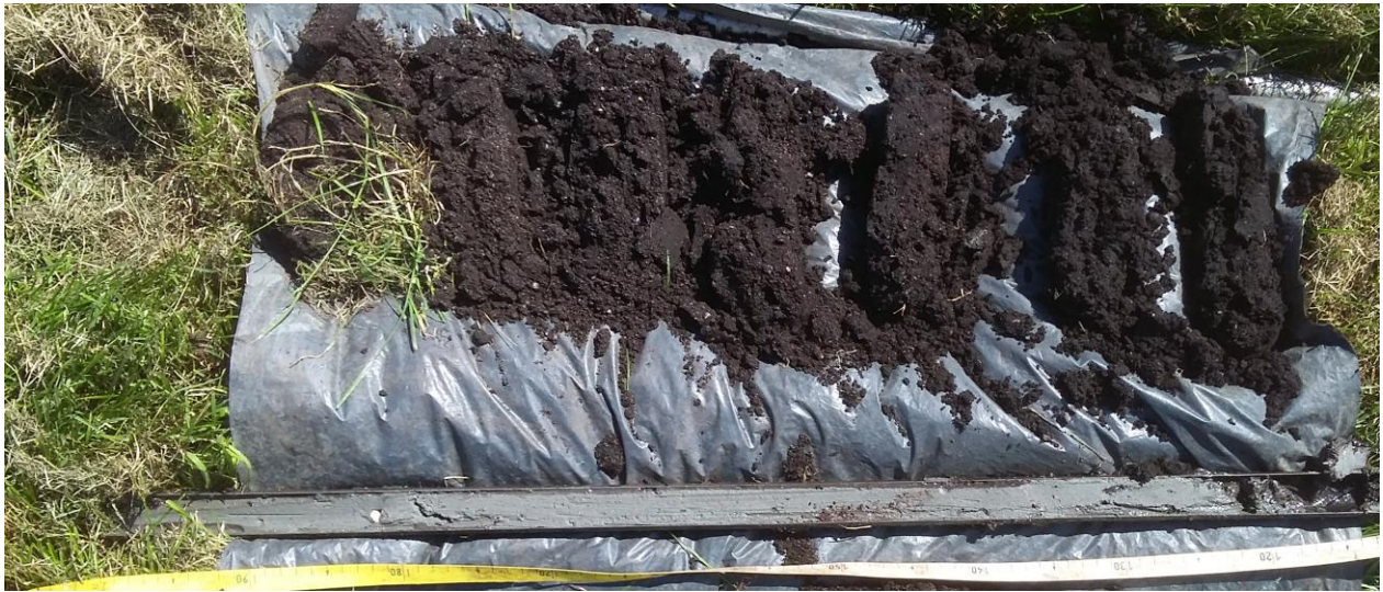
Boring 4: bouwvoor, veen, vanaf 100 cm –Mv klei
