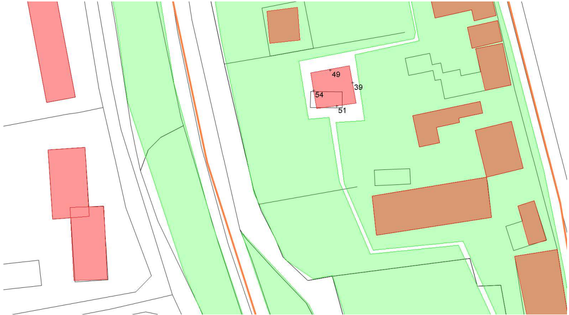
Figuur 3: geluidbelasting vanwege Alkemadelaan in dB, incl. aftrek, hoogste waarde per waarneempunt.
