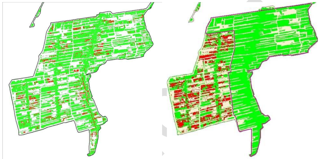
Figuur 6: Knelpuntenkaart Roelofarendsveen conform NBW-normering. Links het beeld voor realisatie van Braassemerland en rechts naar de realisatie van Braassemerland (Bron: Hoogheemraadschap van Rijnland).
