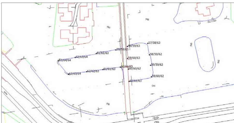
Figuur 4.8: Berekende geluidsbelastingen ten gevolge van de Rijksweg A4, 1 e waarde is begane grond, 2 e waarde is eerste verdieping, 3 e waarde is tweede verdieping
