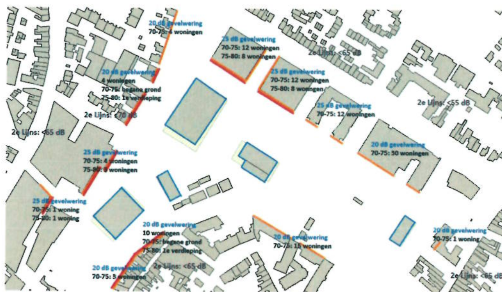
Figuur 4.2 Overzicht gevelbelasting evenement A – categorie I
