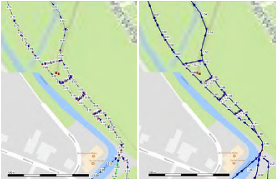
Figuur 29 Stroomsnelheden in m/s (links) en waterdieptes in m (rechts) in de Keutelbeek bij een beekafvoer van 1.2 \text{ m}^3/\text{s} .
